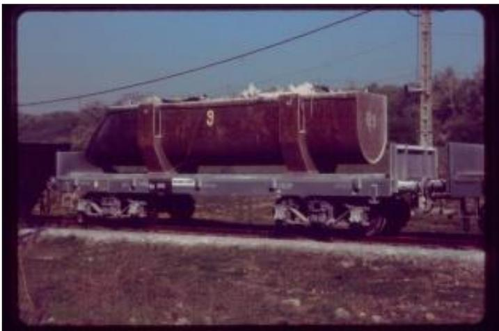
Pour les modélistes qui recherchent des chargements et des usages particuliers, voici l'auget à ferrailles utilisé dans les usines sidérurgiques pour préparer et transporter des charges de vieilles ferrailles et autres adjuvants destinées à l'alimentation des convertisseurs dans les aciéries. (Ci-contre une vieille diapositive prise dans l'usine de Gandrange en Moselle)
